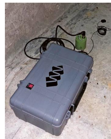
Un sismomètre en place pour des tests dans le cadre de la surveillance sismique.
